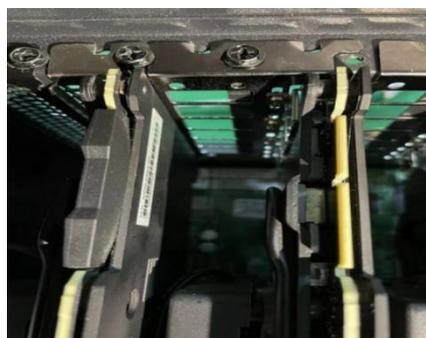
图 3-15 固定 GPU 卡示意图
