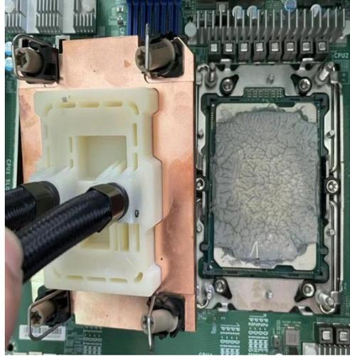
图 4-6 CPU 水冷头安装示意图
