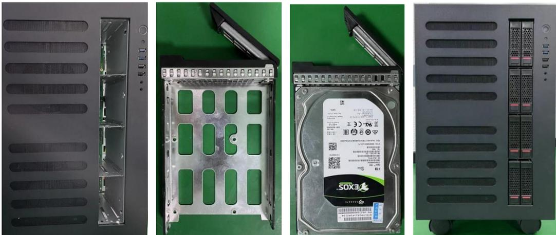
步骤：取出硬盘架→组装→放回硬盘架并锁上
