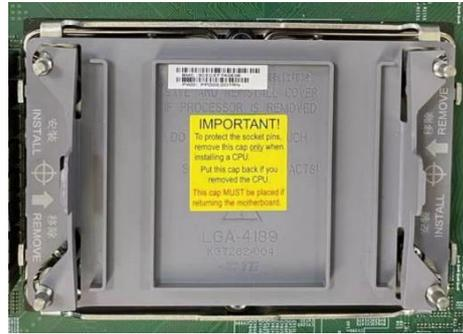
图 4-3 CPU 保护盖示意图
