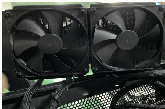
图 3-17 固定水冷排散热风扇示意图
