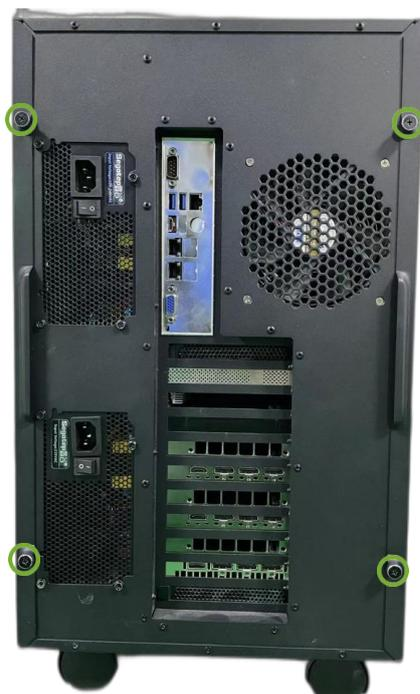
图 4-1 后面板机盖螺丝示意图
